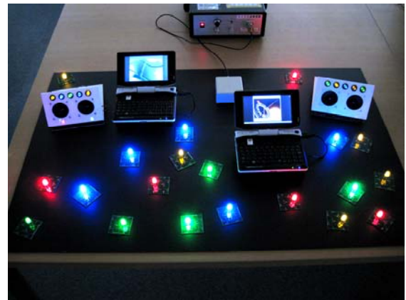
図 1 二次元通信の動作デモの様子。画像中の 2 台の PC はシートを介して通信を行い動画データの読み込み、表示を行っている。また、LED、スピーカなどのデバイスは画像上部のマイクロ波発振器からシートを介して電力供給を受け動作している。通信・電力伝送は全て特別なケーブルを介してシートと直接の電氣的接触なしに行われる。
