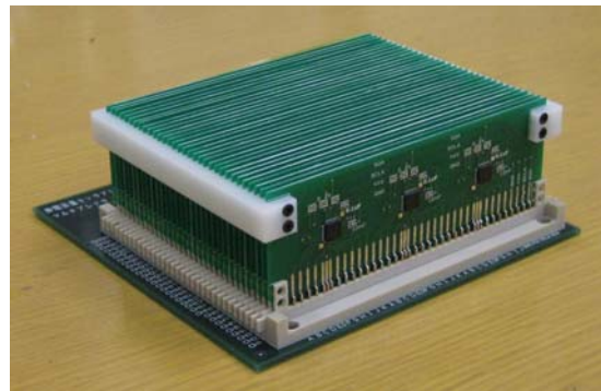
図 6 製作した静電容量センサアレイ。アレイ下部の基板下面に図 5 に示す個々の静電容量センサが 32 \times 32 = 1024 チャンネル配置されている。各センサはアレイの上部に垂直に並べられた基板へと接続される。この基板には静電容量測定回路が実装されている。
