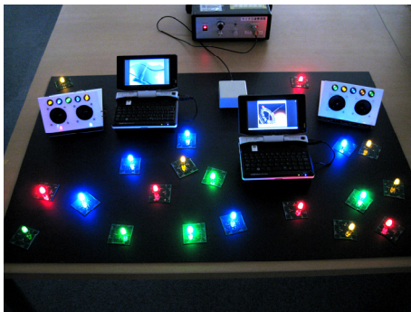
Fig. 1 二次元通信のデモの様子。2 台の PC 間のシートを介したデータ伝送と、LED、ファン、スピーカシステムへの電力伝送を実現している。
